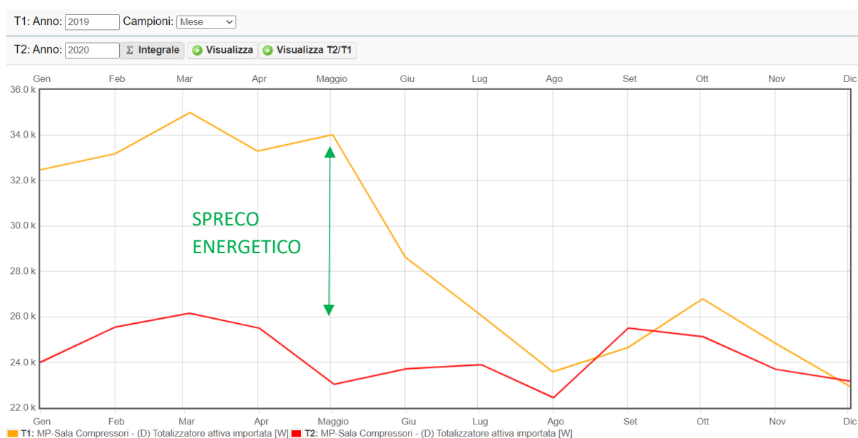
Figura 7.b Consumi di energia elettrica sala compressori 2019-2020.
